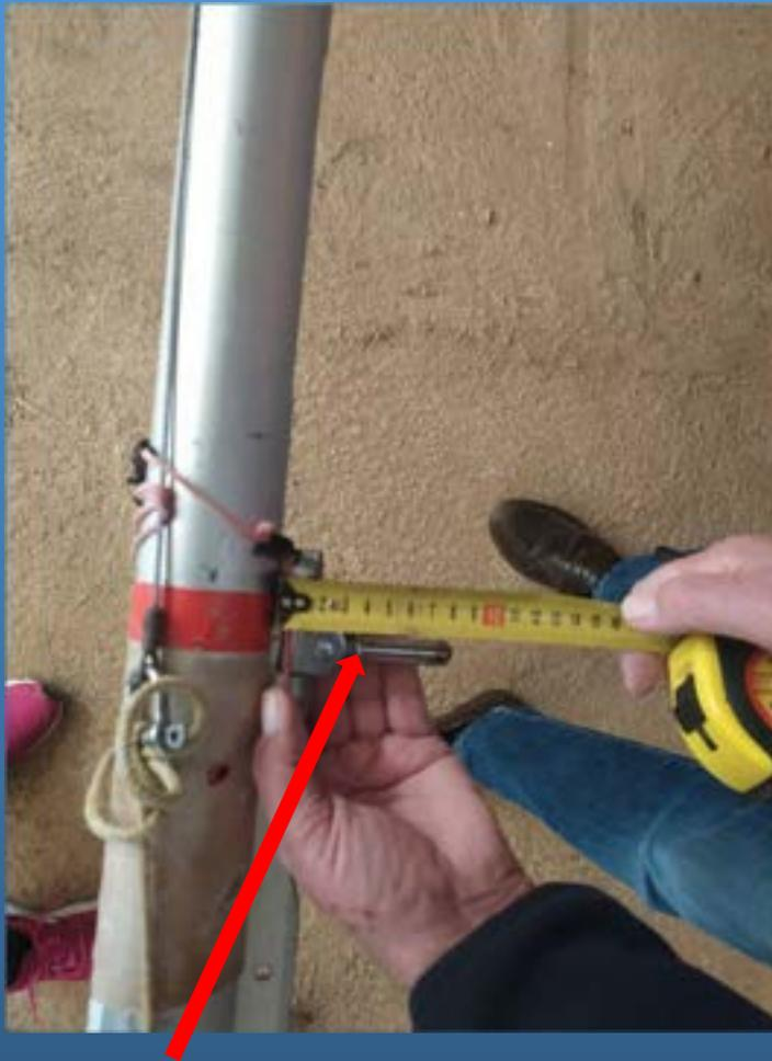
La longitud del pinzote desde la parte posterior del mástil hasta la conexión con la botavara será de 42 mm como máximo
